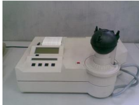
الشكل (45): جهاز تحديد درجة البياض
