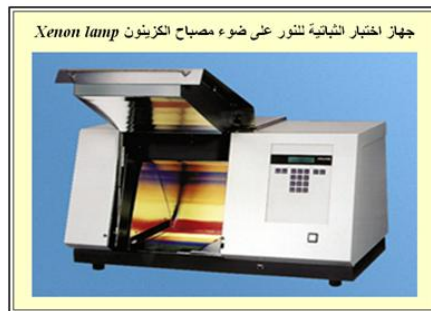
الشكل 1 : جهاز اختبار الثباتية على مصباح الكزنيون
