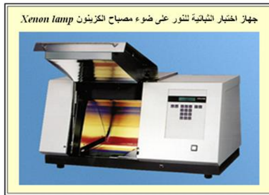
الشكل ٢٢: جهاز اختبار الثباتية على مصباح الكزنيون
