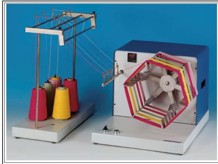
الشكل ١٨ : جهاز قياس نمرة الخيوط والألياف
