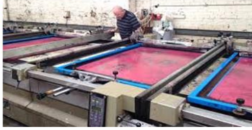
الشكل 185: آلة طباعة القطعة (المروحية) وآلة طباعة النسيج (الفلات)
