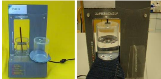
الشكل 171: من أجهزة اختبار فعالية الوتربروف
