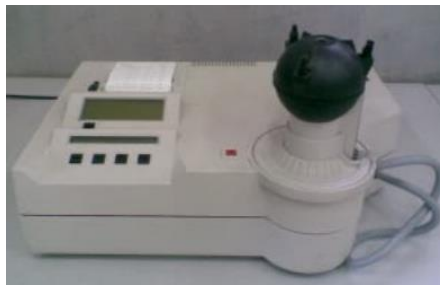
الشكل 55: جهاز تعيين درجة البياض
