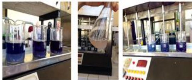
الشكل (١٨): بعض مراحل طريقة التخثير الكيميائي
