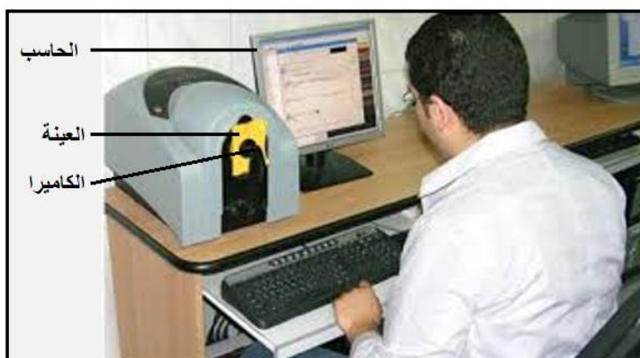
الشكل (١٤٥): العمل على جهاز السبكتروفوتومتر
