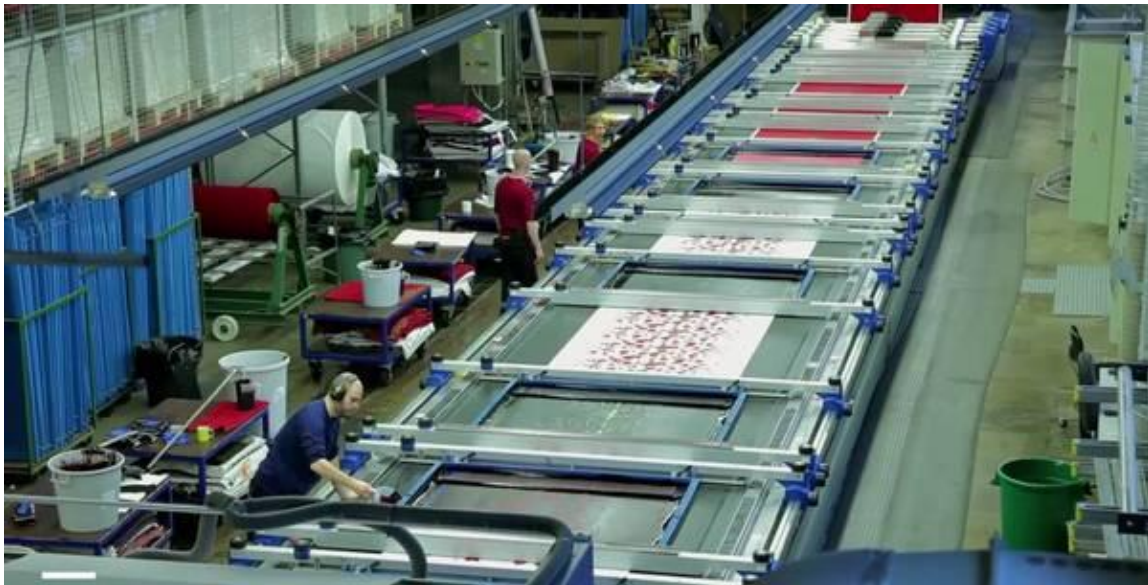
الشكل (١٩٥): آلة طباعة القماش الآلية بالشاشة الكبيرة (الفلات بالشابلون)
