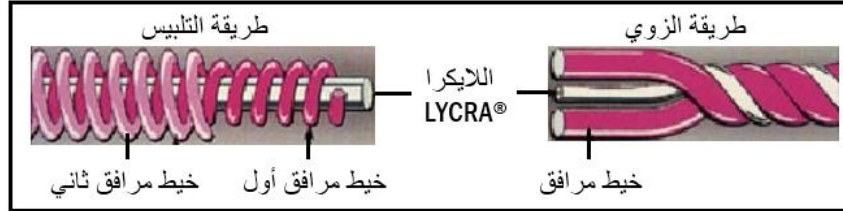
الشكل (١٢٨): طريقتا مزج ألياف اللايكرا بألياف أخرى
