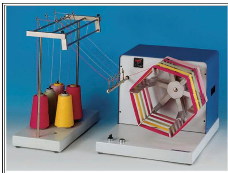
الشكل ٣٣: جهاز قياس نمرة الألياف
