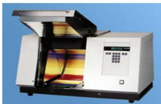
الشكل ٦١: جهاز اختبار الثباتية على مصباح الكزنيون Xenon lamp
