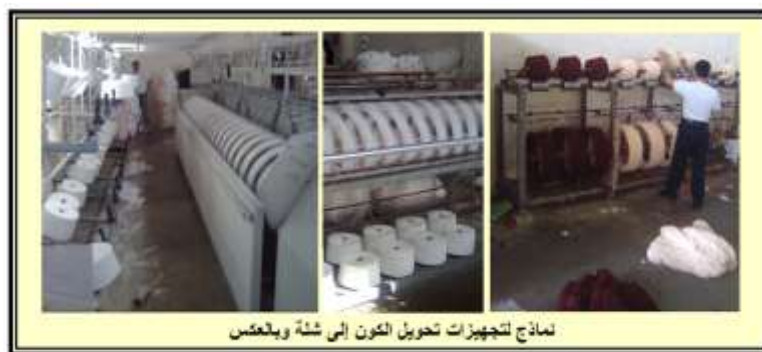
الشكل (158): تجهيزات تحويل الكون إلى شل وبالعكس
