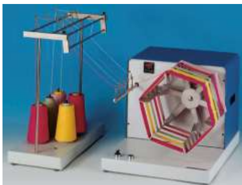
الشكل 51: جهاز تعيين النمرة
