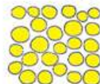
Perlon 3,3 den Polyamid 6, ChS (ebenso Grilon, Bodanyl usw) برلون من البولي أميد 6
