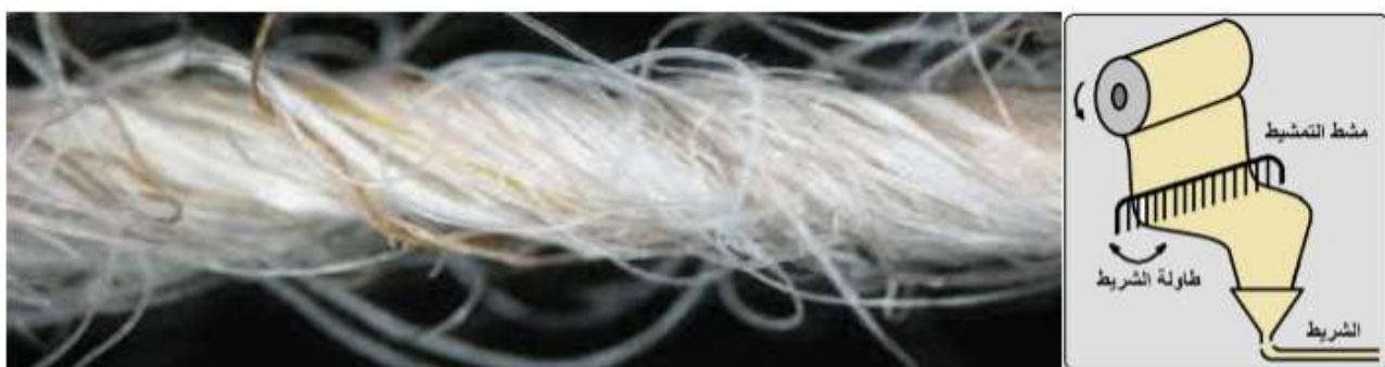
الشكل 40: مشط وطاولة التمشيط
