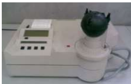
الشكل 55: جهاز تعيين درجة البياض
