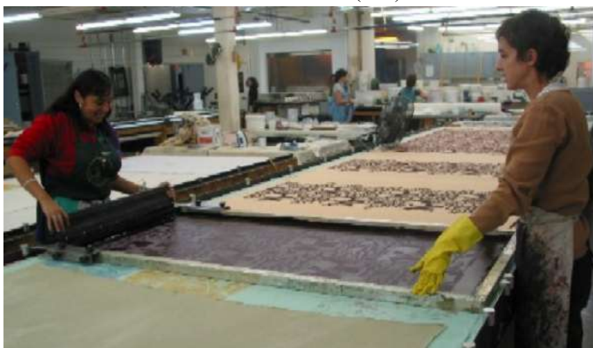
الشكل (194): آلة طباعة القماش اليدوية بالشاشة الكبيرة (الفلات بالشابلون)
