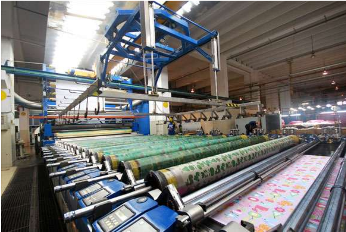
الشكل (196): آلة الطباعة بالشاشة الأسطوانية (الروتاري)
