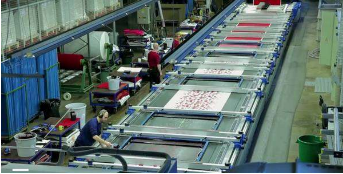
الشكل (195): آلة طباعة القماش الآلية بالشاشة الكبيرة (الفلات بالشابلون)
