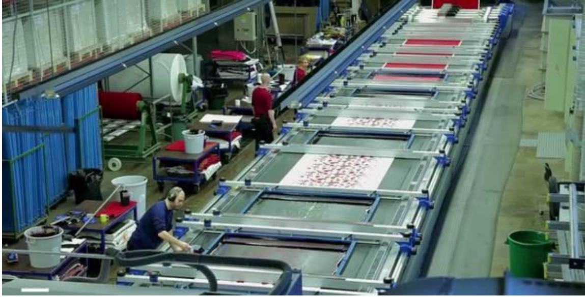
الشكل (١٩٥): آلة طباعة القماش الآلية بالشاشة الكبيرة (الفلات بالشابلون)
