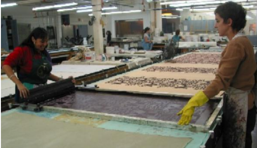
الشكل (١٩٤): آلة طباعة القماش اليدوية بالشاشة الكبيرة (الفلات بالشابلون)
