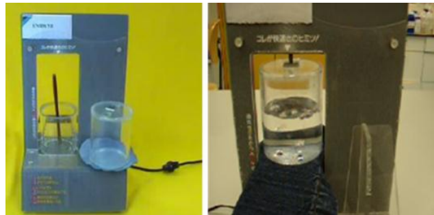
الشكل (١٨٠): من أجهزة اختبار فعالية الوتربروف
