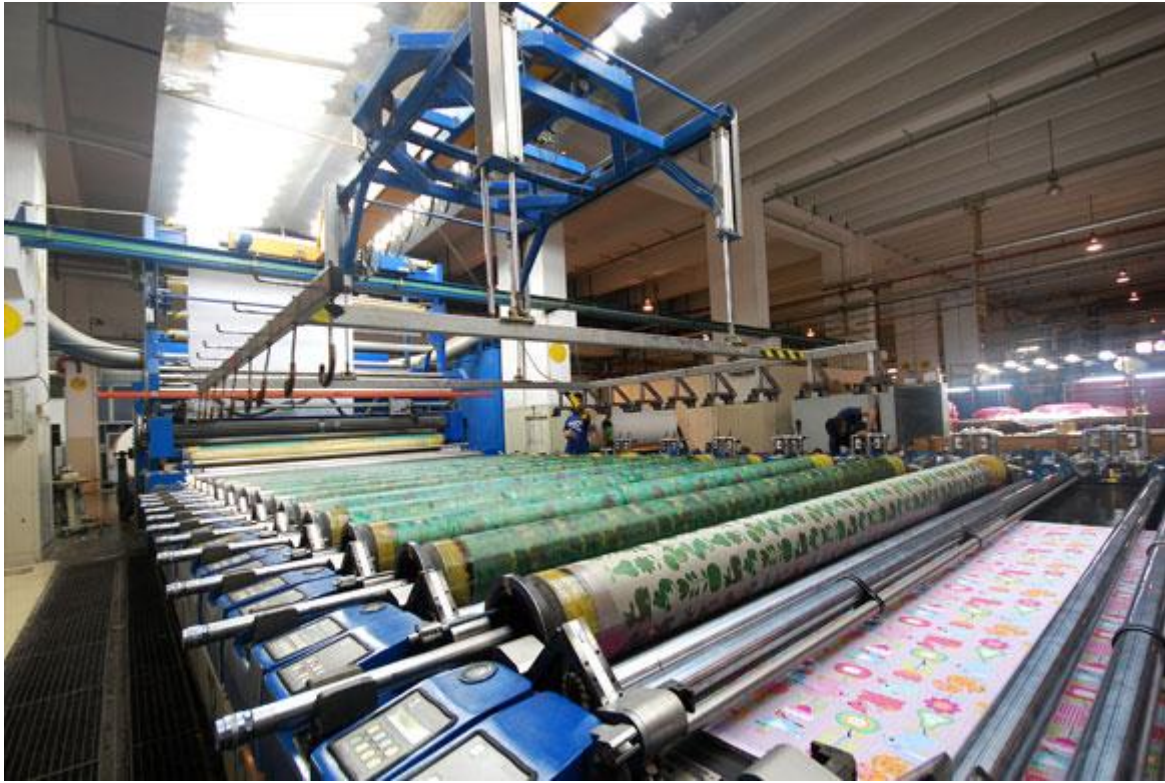
الشكل (١٩٦): آلة الطباعة بالشاشة الأسطوانية (الروتاري)
