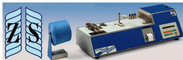
الشكل (٣٨): جهاز قياس عدد البرمات
