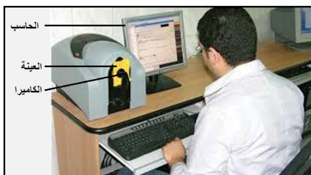
الشكل (١٤٥): العمل على جهاز السبكتروفوتومتر
