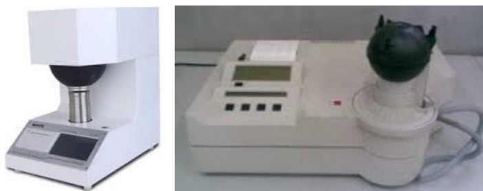
الشكل (٥٦): جهاز تعيين درجة البياض
