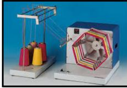
الشكل (٥٢): جهاز تعيين النمرة
